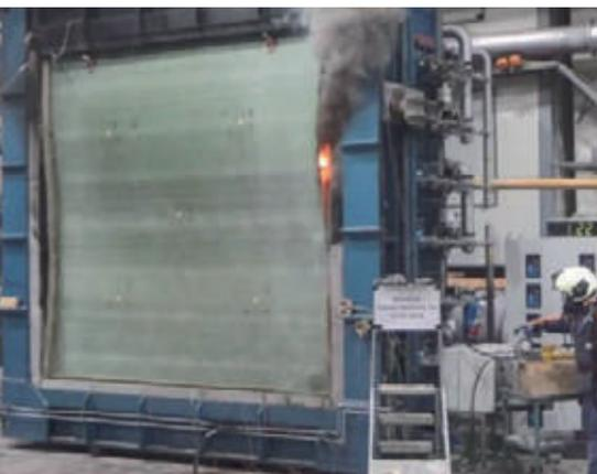
Figura 5. Ensayo de fuego de acuerdo a IMO FTP Code Part 11, tras 82 minutos de ensayo
