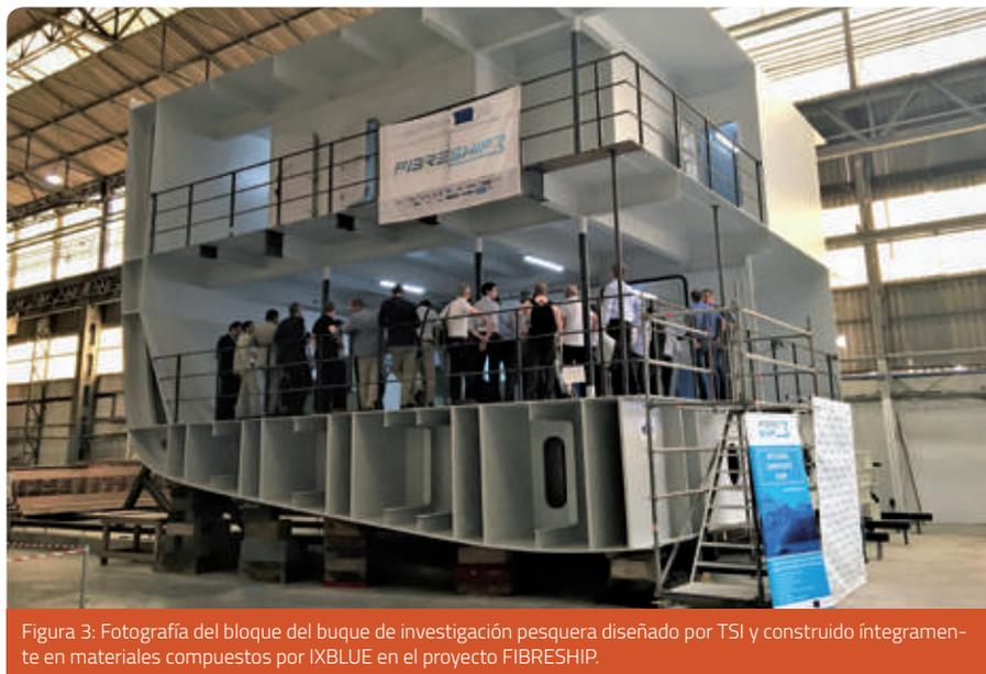
Figura 3: Fotografía del bloque del buque de investigación pesquera diseñado por TSI y construido íntegramente en materiales compuestos por IXBLUE en el proyecto FIBRESHIP.
