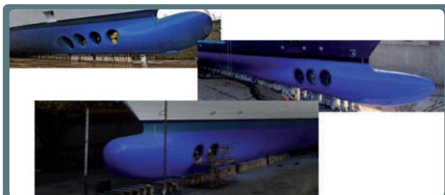
**Figura 10.** Diferentes disposiciones de propulsores auxiliares en proa utilizados en trasatlánticos de gran eslora. Es importante para este trabajo el número y disposición de los propulsores, se puede observar cada buque está acondicionado con diferente número de hélices auxiliares, apareciendo 4 en la imagen superior izquierda, 3 en la derecha y 2 en la imagen inferior. Fuente: Google Images. Fuente: ABB y Google Images
