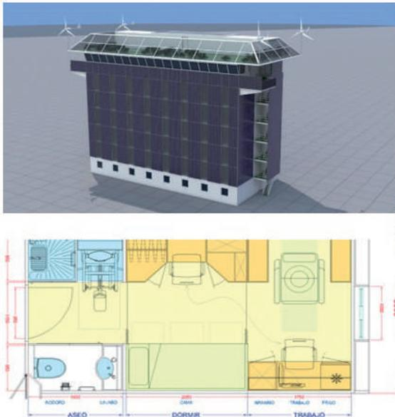
Figura 20. Disposición típica de la cabina de tripulación
