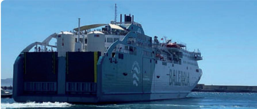
El abastecimiento, que se realizó en coordinación con la Autoridad Portuaria de Algeciras, tuvo lugar a las 20.30 horas de la tarde y se hizo mediante el sistema Truck To Ship (TTS), es decir, desde un camión cisterna hasta los tanques del ferry. Estos tienen una capacidad de almacenaje de 280 m<sup>3</sup>, lo cual permitirá al *Bahama Mama*
