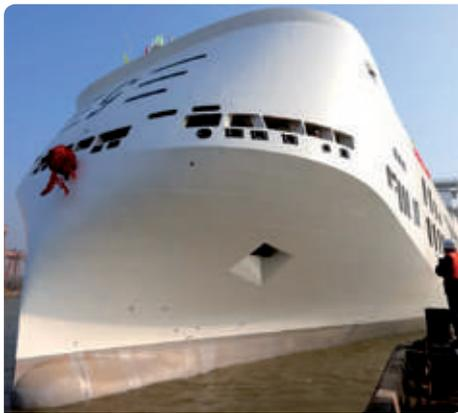
Son ro-ro híbridos, que queman combustibles fósiles durante navegación y electricidad mientras permanezcan en puerto, gracias a que están equipados con baterías de litio que se recargarán durante los periodos de navegación con energía solar ya que tienen instalados a bordo 600 m<sup>2</sup> de paneles solares y/o generadores.
